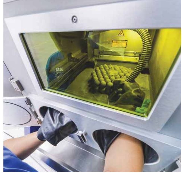
Şekil 3. Makine kapağı açılmadan toz temizleme işlemi, SLM®280 2.0 PSV.
