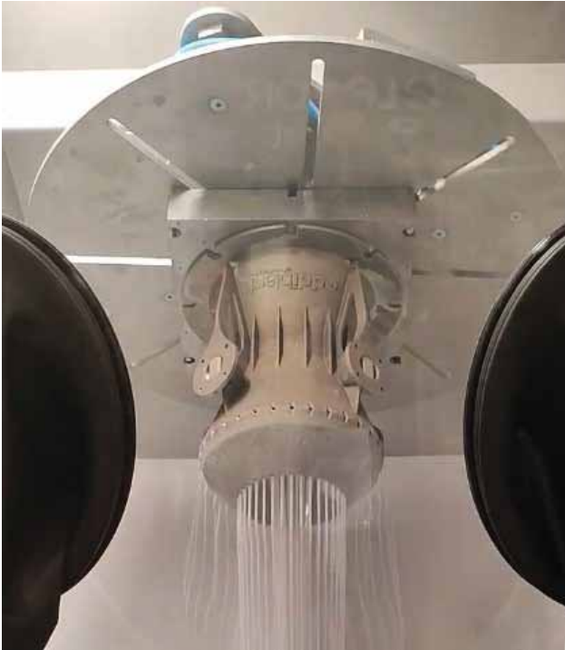
Şekil 4. Addiblast sistemlerinde toz temizleme işlemi.
