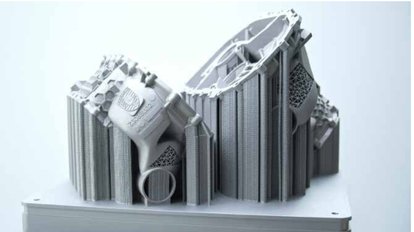
Şekil 4. Seçici Lazer Ergitme (SLM) yöntemiyle 21 saatte üretilmiş Porsche elektrikli tahrik muhafazası. (SLM Solutions)
